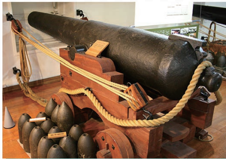
16センチ クルップ砲 ドイツ製 重量 2,855kg 飛距離 3,980m 施条6条有
